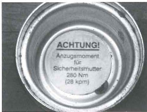
Aanspanmoment voor al-ko lager 280Nm.
