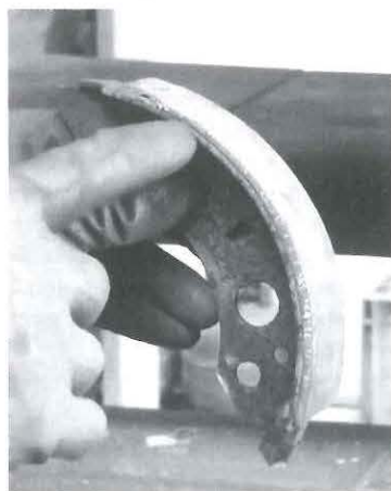
Loskomen van de remvoering van de metalen drager
