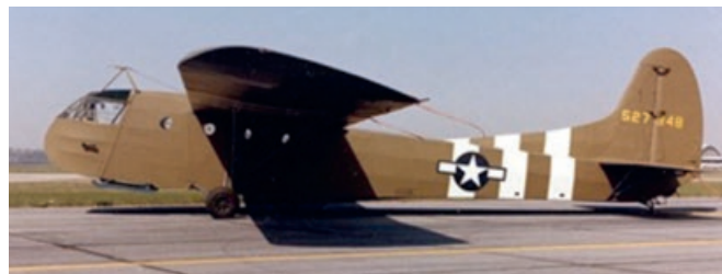
De Waco CargoGlider -4a werd door de Britten Hadrian gedoopt en woog leeg bijna 2 ton. Hij kon nog eens zijn eigen gewicht aan vracht transporteren. (foto National Museum USAF)
