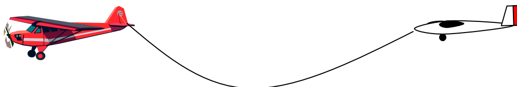
Figuur 7: slap hangende sleepkabel
