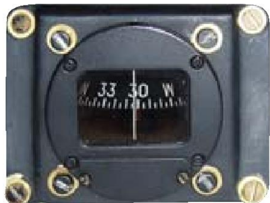
Bolkompas: kompasroos omgezet tot bandvormige rooskaart
