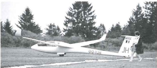
De Rolladen-Schneider LS8a van José Jaime ( RVA ) tijdens de start van de « Standaard » klasse. De winglets aan de vleugels verminderen de luchtweerstand.
