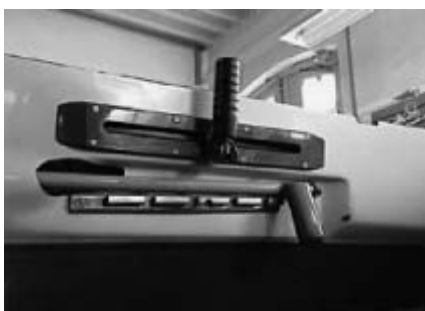
De handsturing voor het richtingsroer (bedrijfsfoto)
